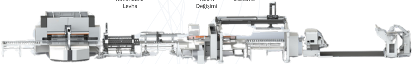
Tam Otomatik Panel Bender Üretim Hattı
